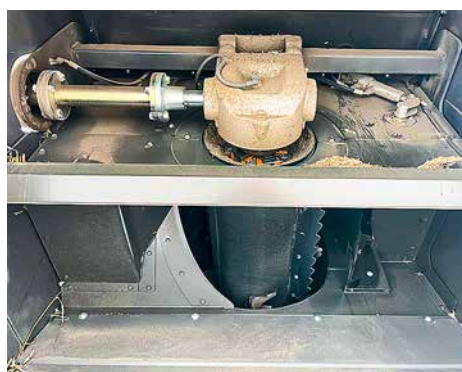
Der Einzelrotor hat einen vergleichsweise großen Umfang, was das Stroh etwas mehr schont als ein Doppelrotor. Rechts ist die hydraulische Verstellung des Auswurfblechs zu sehen, um die Schwadform beeinflussen zu können.
