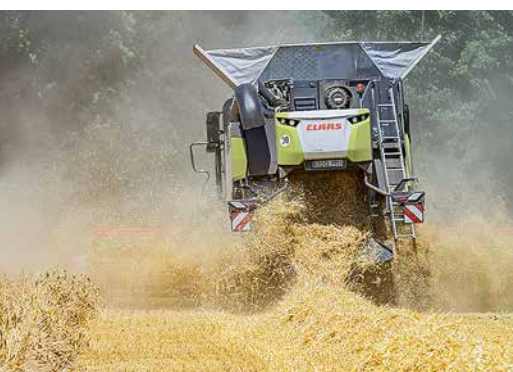
Der Einzelrotor hat einen vergleichsweise großen Umfang, was das Stroh etwas mehr schont als ein Doppelrotor. Rechts ist die hydraulische Verstellung des Auswurfblechs zu sehen, um die Schwadform beeinflussen zu können.
