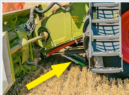
Auf Knopfdruck lösen die Magnete den Rahmen und die Schale gleitet auf den Boden.
