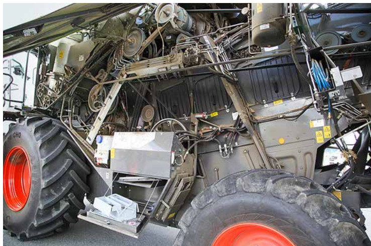
Aufgeräumte Antriebe, Werkzeugkasten, Handwaschbehälter und auch hinten ein Luftschlauch – hier fehlt es an nichts.
