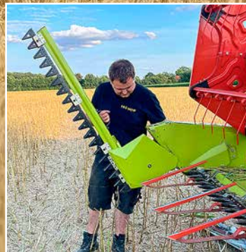
Das 7,70 m Vario-Schneidwerk macht super Arbeit und ist ruck zuck von Getreide auf Raps umgebaut. Empfehlen würden wir aber das V930 mit 9,30 m Schnittbreite.
