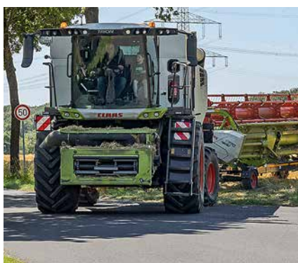
Selbst mit den 2,05 m hohen 800er Rädern bleibt der Trion unter 3,50 m Außenbreite. Alternativ gibt es auch Terra Trac-Laufwerke.
