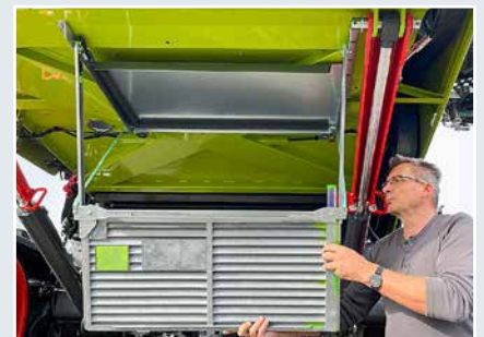
Mit etwas Übung muss man zum Einlegen der Schale nicht unter den Schrägförderer.
