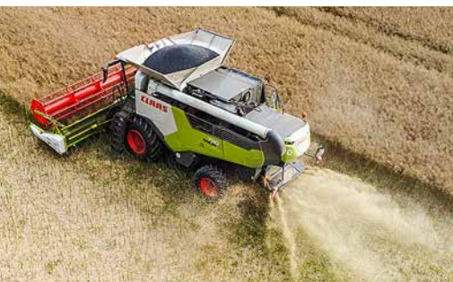
Der Häcksler schafft die 7,70 m locker ohne Radialverteiler, 12 m 3 Korntank sind super.
