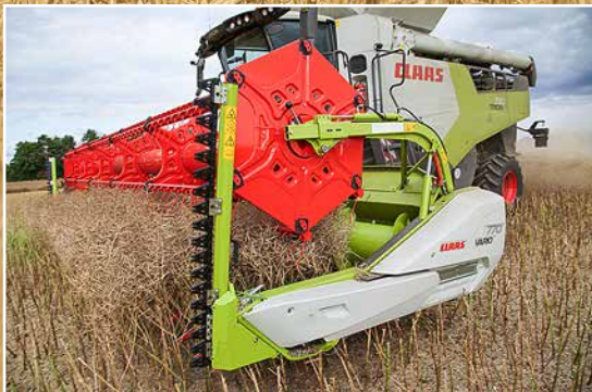
Das 7,70 m Vario-Schneidwerk macht super Arbeit und ist ruck zuck von Getreide auf Raps umgebaut. Empfehlen würden wir aber das V930 mit 9,30 m Schnittbreite.
