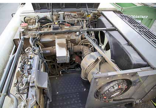
Der Cummins leistet 408 PS, die man auch gut gebrauchen kann. Luftfilter und Kühler müssen nur sporadisch gereinigt werden.
