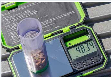
Das abgelesene Gewicht von der mitgelieferten Feinwaage kann in die App eingegeben werden, Tara ist hinterlegt. Nach Eingabe der Randparameter werden die Verluste berechnet.
