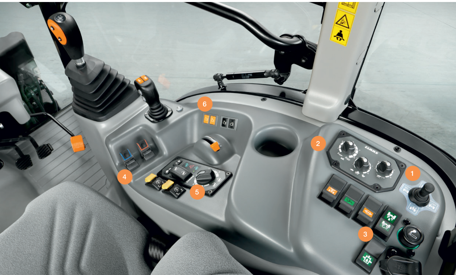
1. Verstellung der hydraulischen Hubstrebe und der hydraulischen Seitenstabilisatoren | 2. Einstellungen des Heckkrafthebers | 3. Verriegelung der Seitenstabilisatoren 4. Bedienung der elektrohydraulischen Steuerventile | 5. Steuerung des Heckkrafthebers | 6. Motordrehzahlspeicher
