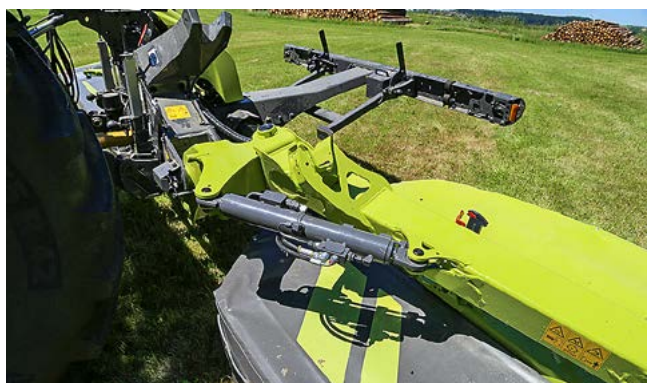
Der Zylinder hat die Doppelfunktion „Überlastsicherung“ und „Mähwerkneigung“. Die grauen Tücher sind das Erkennungszeichen der neuen Maschinen.
