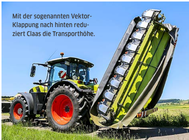
Der Zylinder hat die Doppelfunktion „Überlastsicherung“ und „Mähwerkneigung“. Die grauen Tücher sind das Erkennungszeichen der neuen Maschinen.
