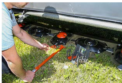
Der Klingenkasten ist offen, die Farbgebung der Klingen erleichtert die Zuordnung der Drehrichtung.
