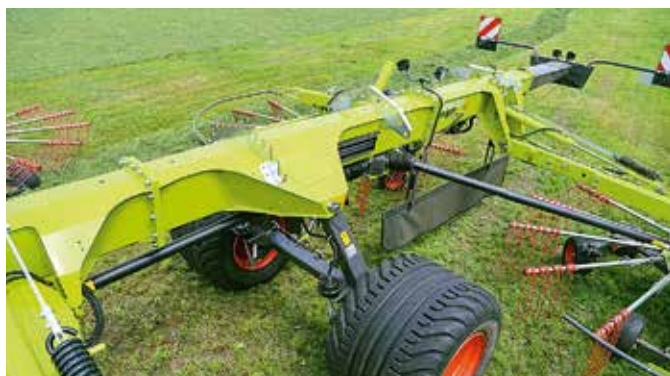
Der Rahmen hat einen trapezförmigen Querschnitt, der Stabilität bieten soll. Im Zentralholm sind Elektronik- und Hydraulikkomponenten untergebracht.
