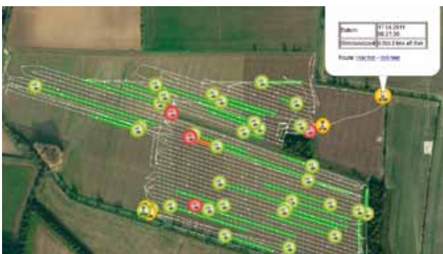
Das Telematics kann die Fahrspuren sowie Statusmeldungen der Maschine in Google Earth darstellen. Damit lässt sich die Ernte schlagbezogen nachvollziehen.
