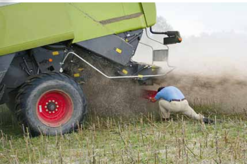
Uwe Schmidt ist sich nicht zu schade, dahin zu gehen, wo es juckt! Hier ermittelt er die Rotorverluste, um sie den Fahrern mitzuteilen.
