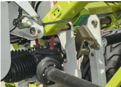
Jeder Kreiselarm ist mit einem Drehwinkel-sensor ausgestattet, der die Aushubhöhe
