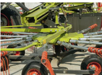
Der Sensor oben auf dem Gehäuse des Teleskopzylinders erkennt die Schwadbreite.
