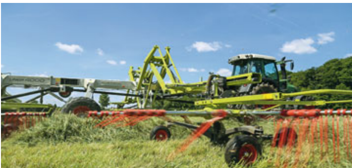
Auch die Arbeitsbreite und die Rechhöhe sind über das Terminal elektronisch einstellbar.
