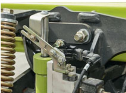
Hier überwacht ein weiterer Drehwinkel-sensor die Rechhöhe.
