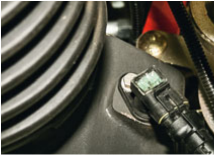
Der Drehzahlsensor am Getriebe kontrolliert, ob sich die Kreiselantriebe bewegen.
