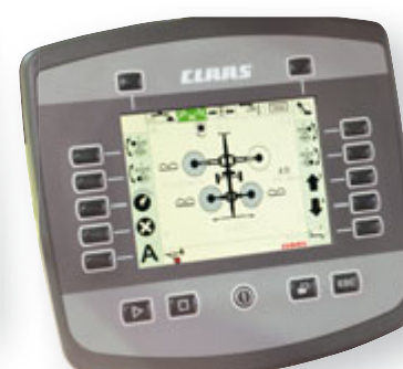
Die Kreisel lassen sich manuell auch einzeln heben und senken.
