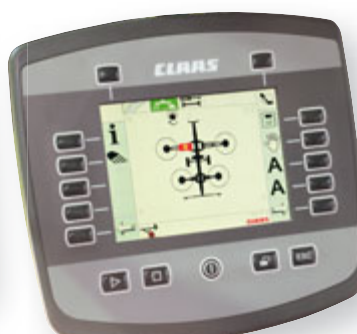
Das Blitzsymbol zeigt die Position eines defekten Sensors.
