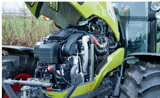
Italienischer Kern: Der Farmotion-Motor von SDF erfüllt dank Abgasrückführung und Diesel-Oxidations-Katalysator die Abgasstufe IIIB.
