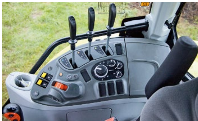
Alles an seinem Platz: EHR-Bedienung und Steuerventile auf der rechten Konsole.
