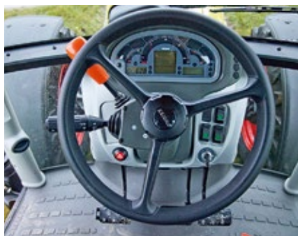
Das Armaturenbrett ist informativ; die lastschaltbare Wendeschaltung links unter dem Lenkrad kann in ihrer Aggressivität verstellt werden.
