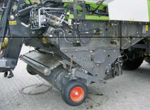
Das Lade- und Schneidaggregat lässt sich komplett in nur 15 Minuten ab- und anbauen.
