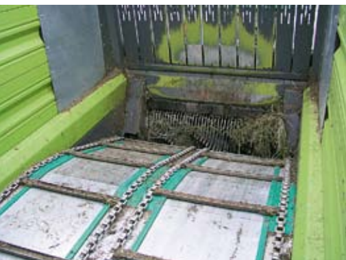
Der Boden ist vorne um 44 cm abgesenkt, so dass der sonst übliche Förderkanal über dem Rotor entfällt.
