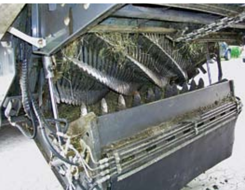
Die 40 Messer (hier sind nur 11 eingesetzt) lassen sich mit hydraulischer Unterstützung werkzeuglos herausnehmen.
