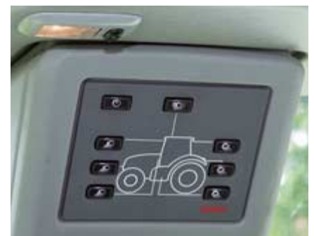
Die Licht-Anlage bietet in Serie 14 (!) Arbeitsscheinwerfer und ist sehr gut bedienbar.
